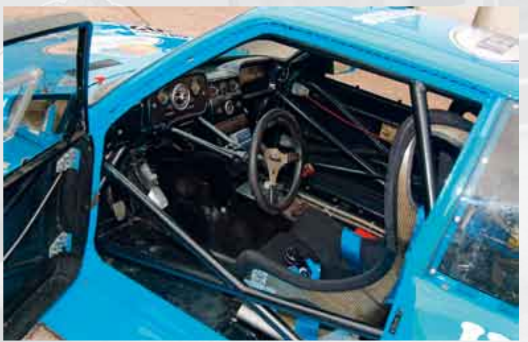
Birdcage: Der Innenraum weist zahlreiche versteifende Streben auf
