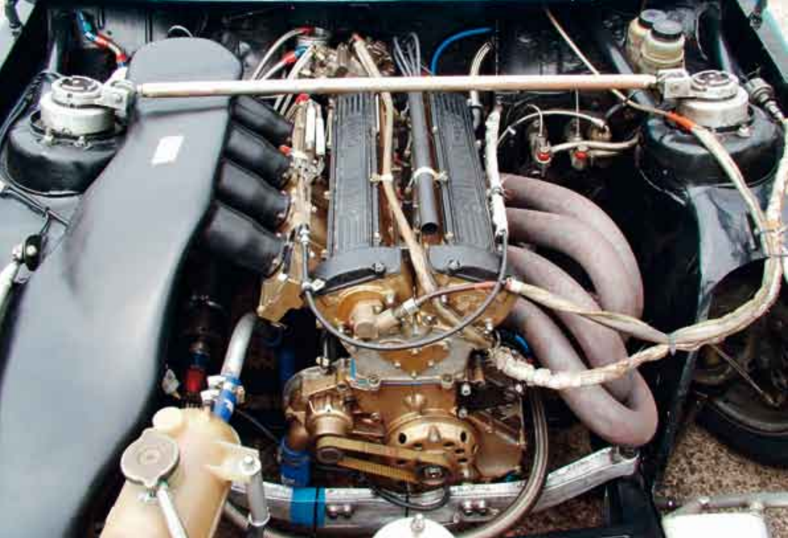
Formel-2-Brenner: Das 310 PS starke Vierzylinder-Triebwerk basiert auf der Konstruktion des genialen Ludwig Apfelbeck
