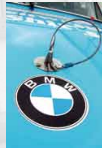
Typisch Motorsport: Schnellverschlüsse sichern die Hauben
