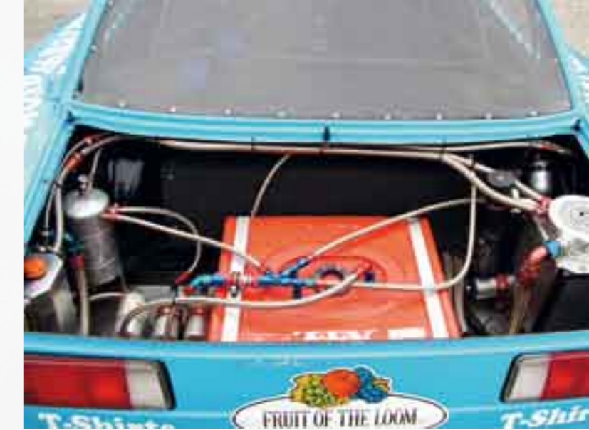
Professioneller Kofferraumbau: Unter der Heckklappe wird der Rennsport-Tank offensichtlich
