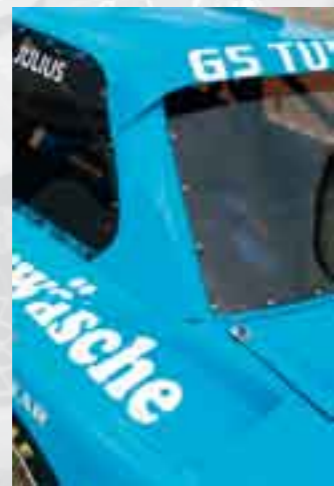
Leicht gebaut: Die Seitenscheiben und die Heckscheibe bestehen aus dem Kunststoff Makrolon
