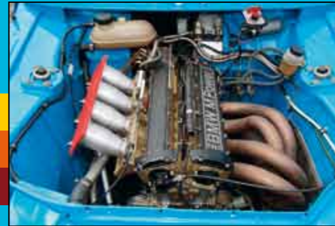
Ein starkes Stück: Zwischen den Stehwänden wirkt ein 285 PS leistender Formel-2-Motor
