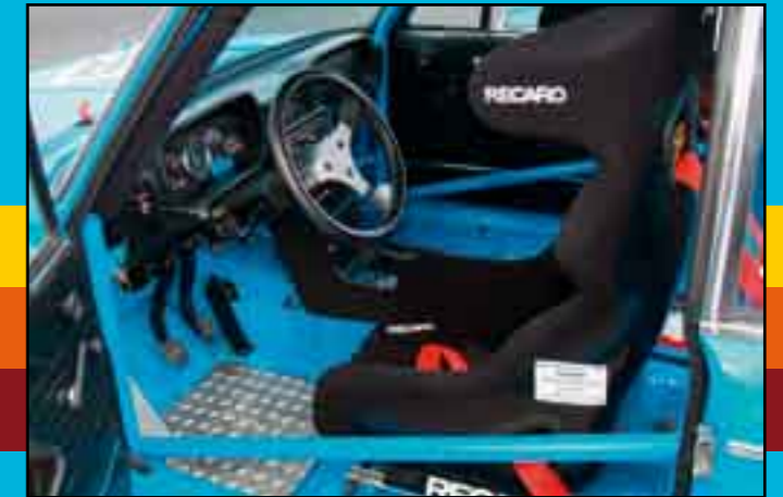
Zweckmäßig: Das karge Innere ist mit einer modernen Recaro-Schale und einer geschweißte Sicherheitszelle ausgerüstet
