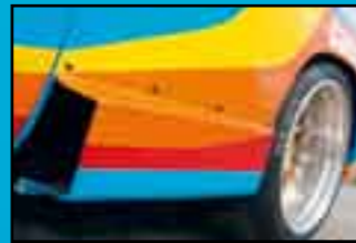
Etwas aufgesetzt: Die seitlichen Luftschächte führen Kühlluft an die Bremsen und die Hinterachse
